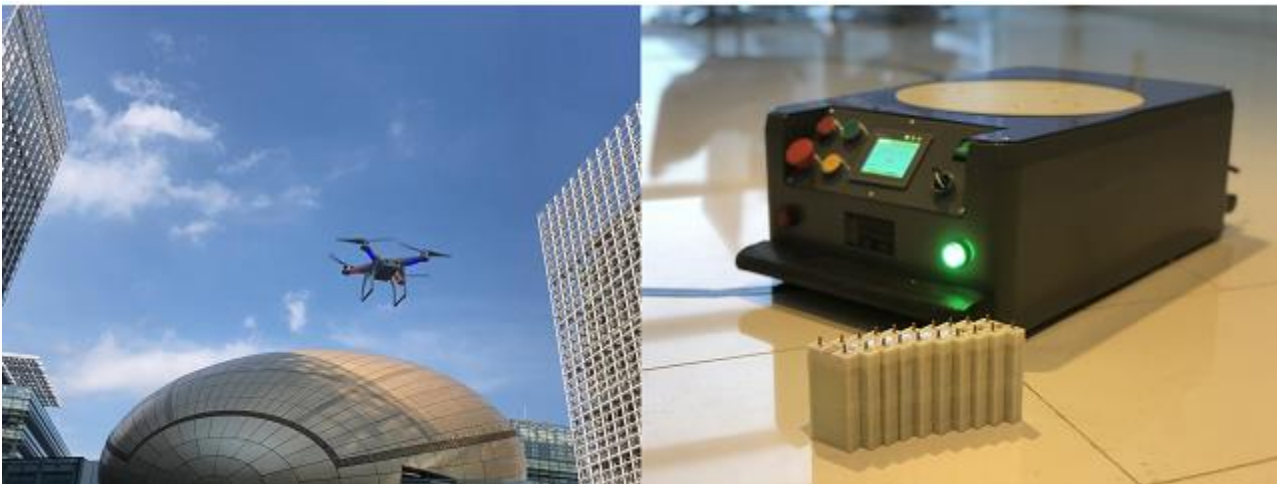
4/6 史博士的團隊發明的先進水系電池，可應用於無人機和機器人上，擁有防爆、安全及環保的優點。
