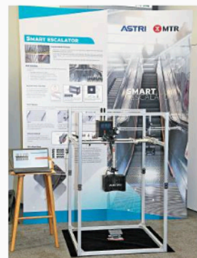
▲港鐵與應科院聯合研發扶手電梯梯隙測量儀器。
