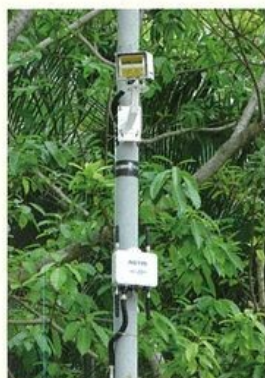
● 科學園迴旋處加裝光學雷達探測行車路上的行人，既不侵犯私隱，又向司機提供安全訊息。
