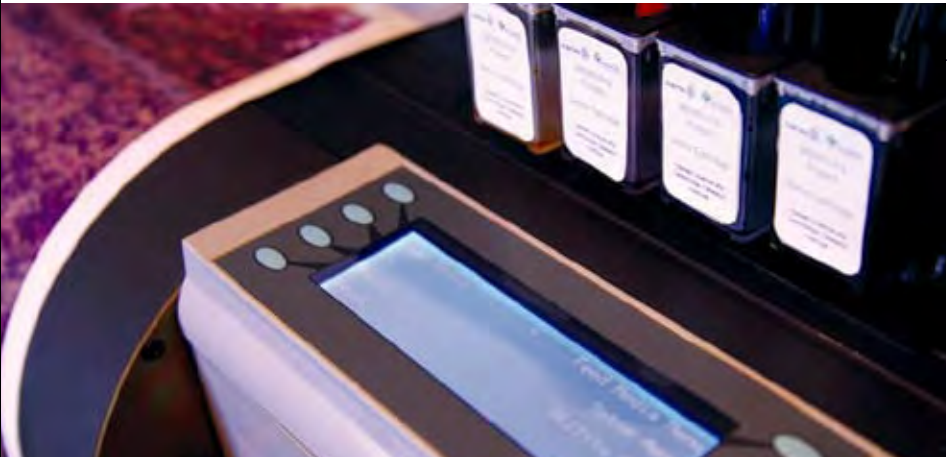
The first ASTRI-made print head named China Head 應科院製造的第一台噴墨印頭，名為「中國頭」
