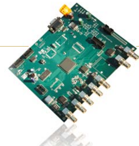
✦ SFN adapter used for DTMB system. 用於DTMB系統中的單頻網調試器。
